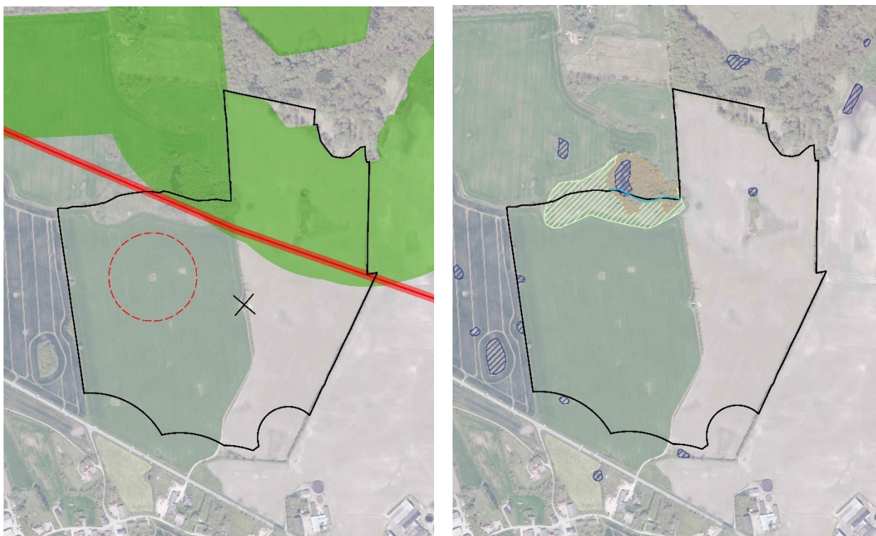
Figur 4: Til venstre: 150 kV luftledning inkl. deklarationsareal, der gennemsårer området er vist med rød, fortidsmindebeskyttelseslinjen på 100 meter er vist med rød stiplede linjen, skovbyggelinjen er vist med grøn og den omtrentlige placering af vindmøllen er vist med et sort kryds. Til højre: § 3 beskyttede naturtyper – grøn: eng, blå: sø, brun: mose.
