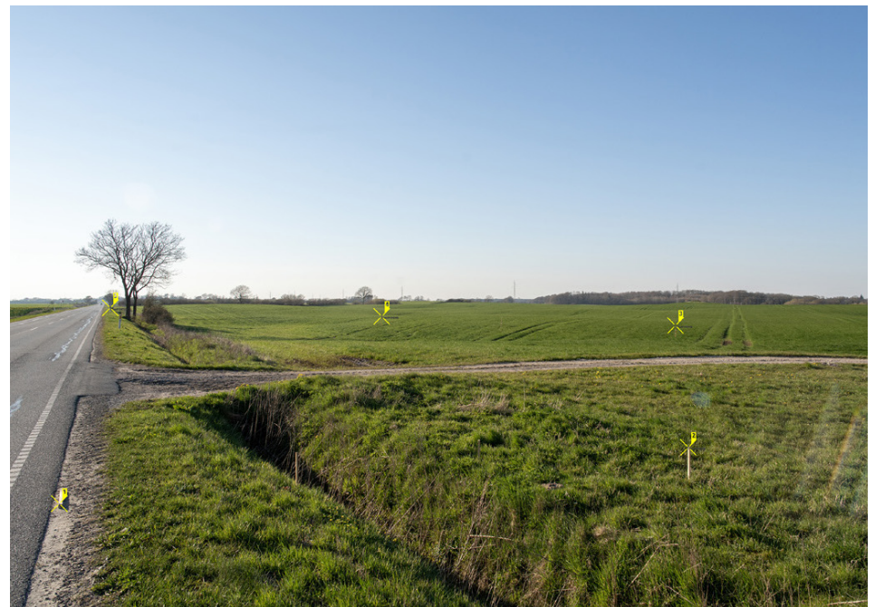
Eksempel på metode for målfaste visualiseringer. Fotografi, opmålte punkter og markeringsspinde.
